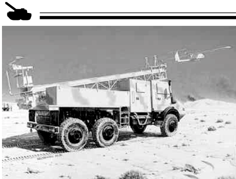
Рис. 8. Запуск с пусковой установки БЛА FOX TX
