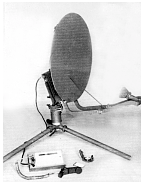
Рис. 3. Наземный портативный терминал СПТ в развернутом виде
